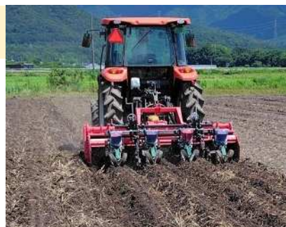
湿害による出芽不良を回避することができる大豆の高速播種機
