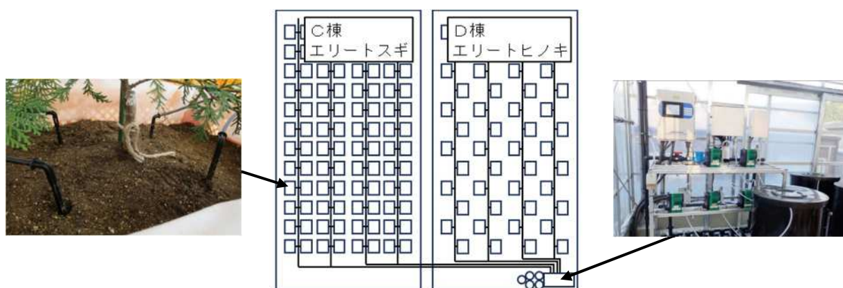
液体肥料自動供給システム 22 による施肥・灌水
