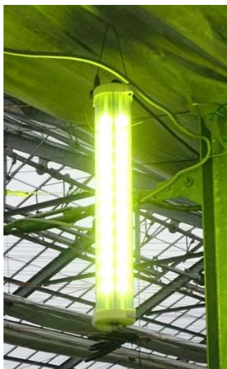
実証試験に利用した防虫用 LED アグリインセクト PF 緑（アルファクス株式会社 (25.9W)）
