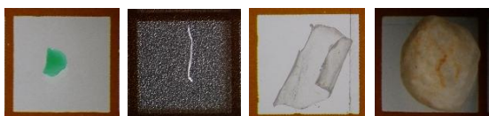
写真3 測定したプラスチック粒子の一例 (左からフラグメント、繊維状、膜状、肥料殻) ※格子の一辺は5mm
