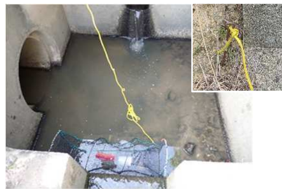
ひもを付けて構造物やロープ止め用金具などに固定
