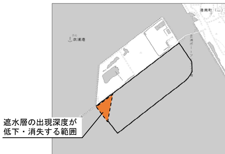
図 4.1-1 底面遮水層の分布状況
