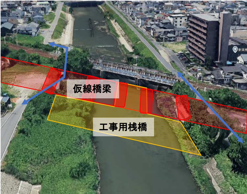
＜五条川仮橋梁付近イメージ図＞ R8年11月上旬より鋼管杭打設・下部工構築作業開始予定 R9年10月頃から工事用栈橋工事開始予定
