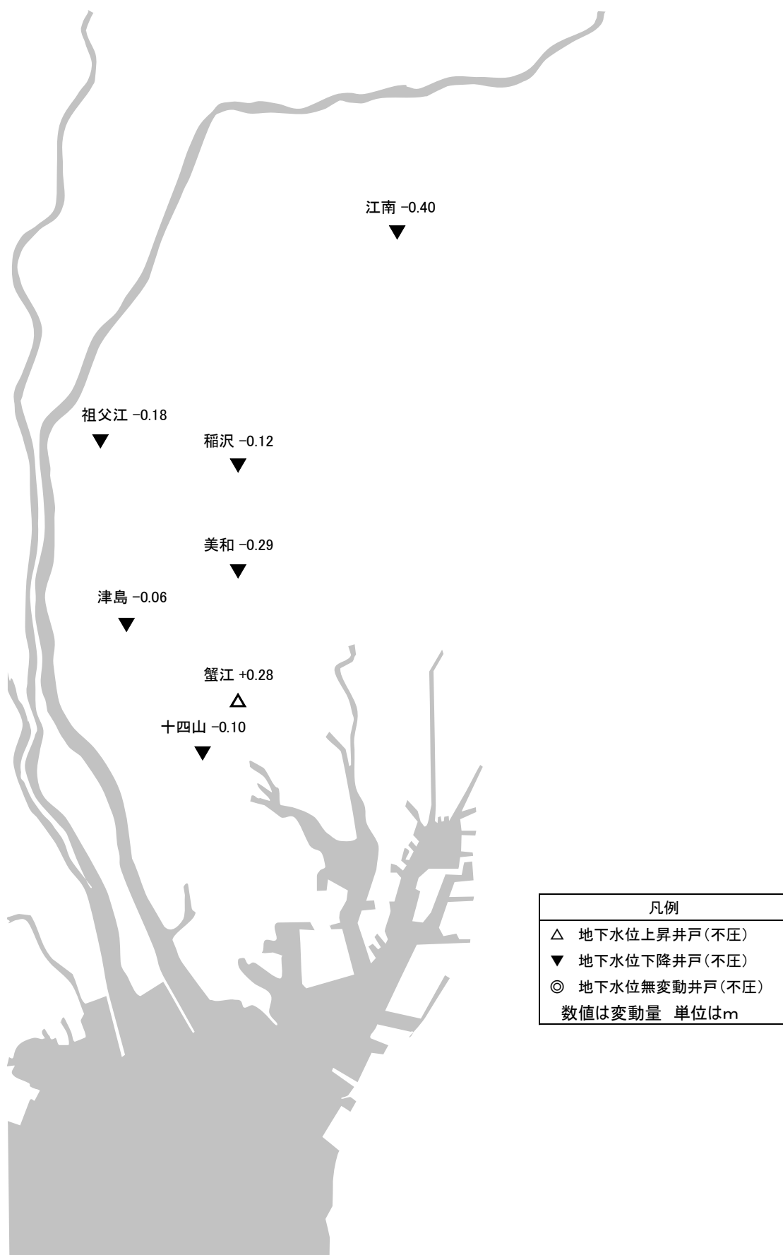
図 2 - 2 観測井不圧地下水位変動状況 ( 7 井 ) ( 2024 年と 2025 年の平均地下水位比較 )
