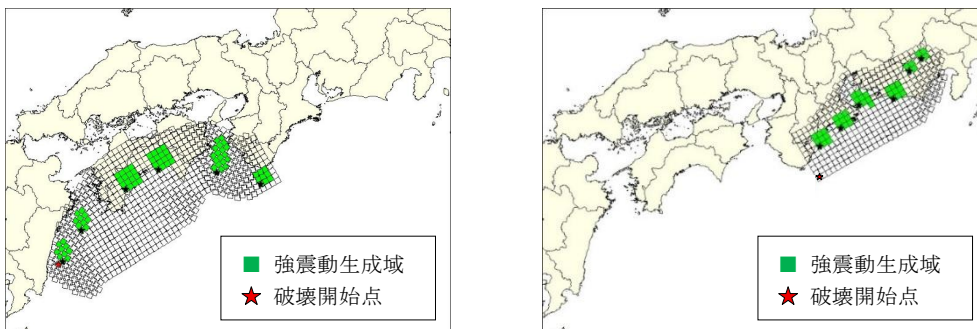
図 1-4 半割れ地震（理論上最大モデル）の強震断層モデル（内閣府（2025）） （左：西半割れ地震、右：東半割れ地震）
