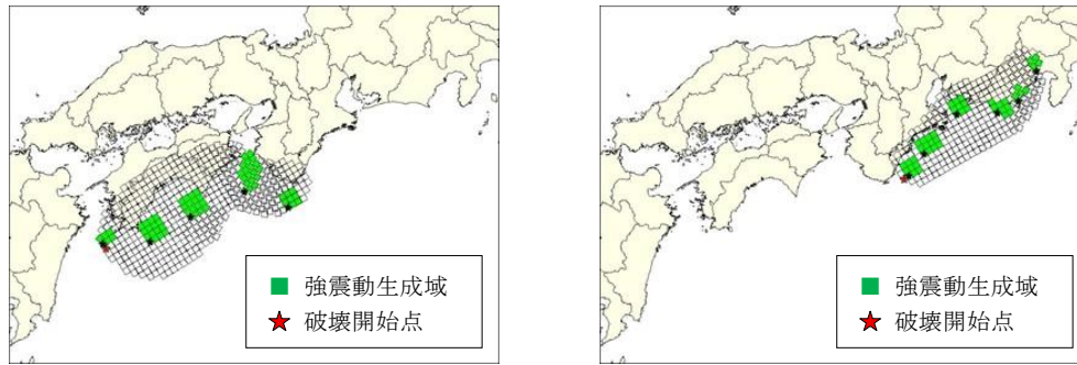
図 1-3 半割れ地震（過去地震最大モデル）の強震断層モデル（内閣府（2015）を基に作成） （左：西半割れ地震、右：東半割れ地震）
