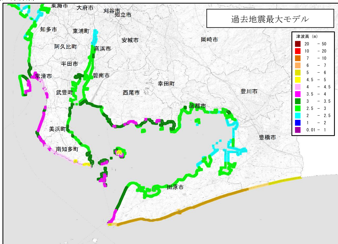
図 6-9 過去地震最大モデルの津波高 (朔望平均満潮位 地殻変動量考慮)
