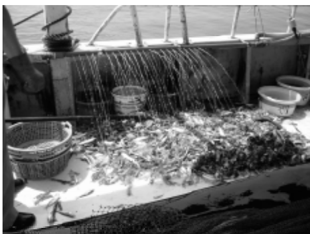
Fig. 3 海水を散布している状態のシャワー装置 Picture of the shower equipment scattering seawater on the trawl landings.
