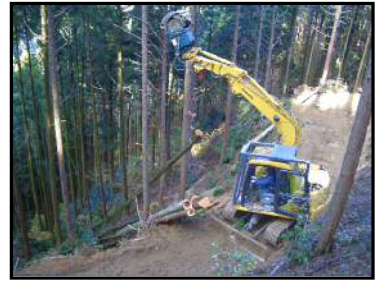
スイングヤーダによる集材作業
