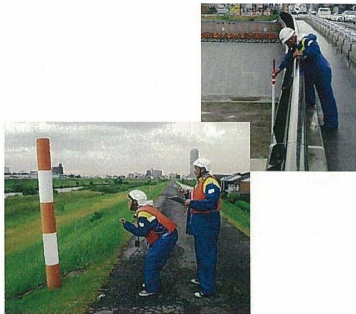
② 流速計による観測状況（中部地方整備局提供）
