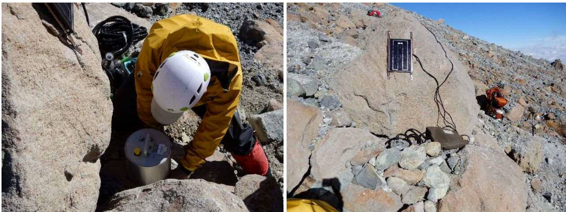
写真 5 御嶽山剣ヶ峰下の観測点設置（2017 年 10 月 17 日）。（左）地震計設置の様子（右）設置完了後。地震計の周りには風よけのための石が積んである。岩に取り付けてあるのは太陽電池パネル（2 面）。記録計は焦げ茶色の袋に梱包されている。
