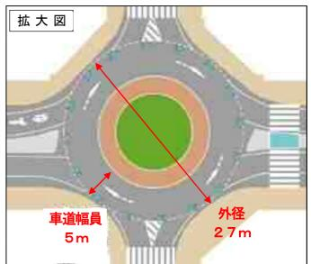
ラウンドアバウト導入よる交差点形状の変化
