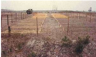
S53:埋立直後の田原町トヨタ工場予定地 飛砂防止用緑化工実験区
