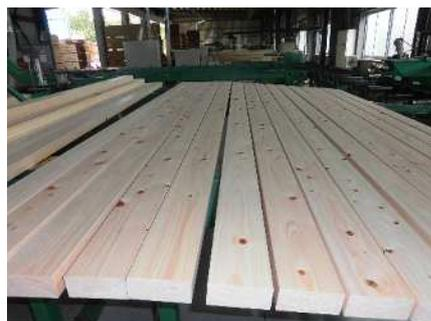
JAS 人工乾燥処理構造用製材
