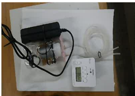
加湿器への給水用、ポンプとタイマー
