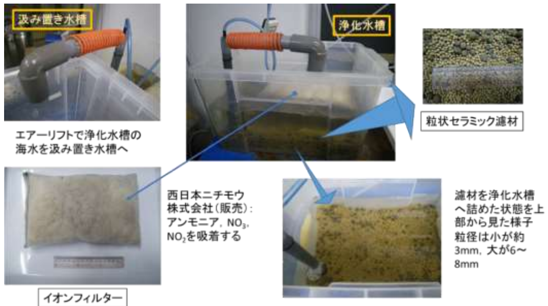
図2 循環ろ過システムに利用したエアリフト及び濾材
