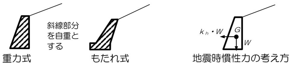
図4. 3-82 考慮する擁壁の重量および地震時慣性力の考え方
