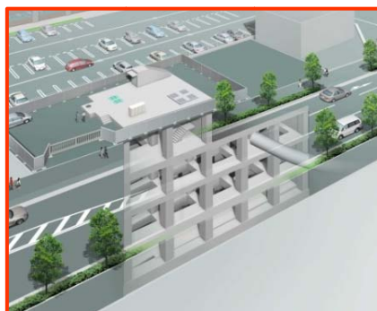
浸水への対応能力の強化 (一宮市北園通貯留槽パース図)
