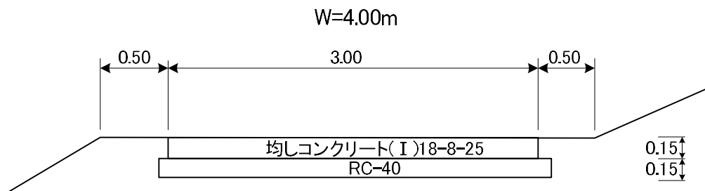
図 1-1-3 コンクリート路面工とする場合
