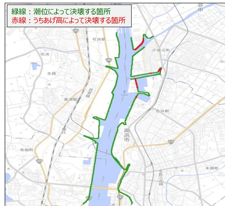
図 海岸堤防の決壊条件（衣浦の例）
