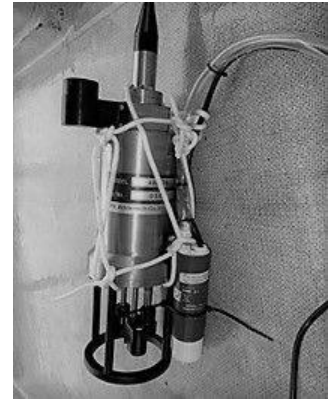
図2 小型水中ポンプを結束したCTDゾンデ
