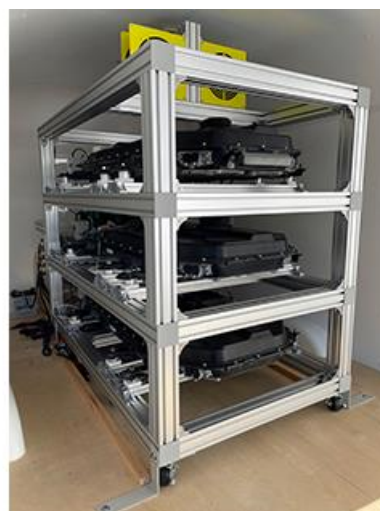
バッテリーキューブに搭載しているリユースバッテリー
