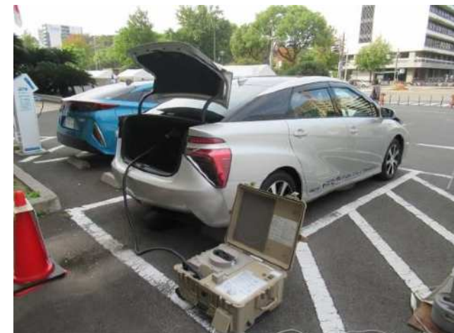
外部給電器を用いた給電デモ
