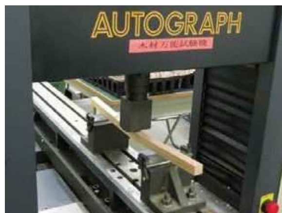
材質調査(曲げ強さ等の測定)
