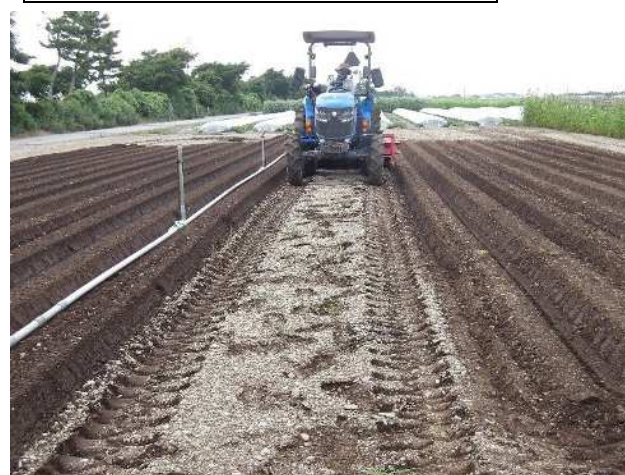
【自動操舵システムによる畝立て作業】
