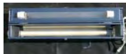
光触媒養液殺菌装置（上）と内部構造（下） 配管内に二酸化チタンを担持させた筒状ガラス繊維を設置し、紫外線を照射する装置
