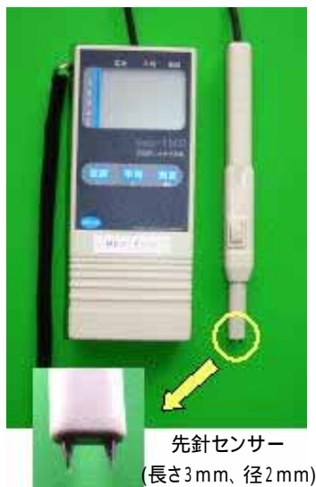
図 -3-2-1 電気抵抗式水分計
