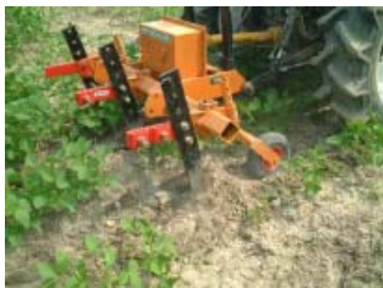
図 -3-4-1 市販機による 心土破碎作業
