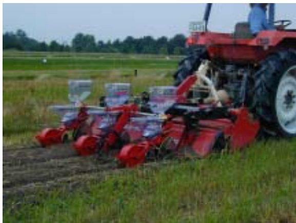
図 -5-2-2 スリット播種作業
