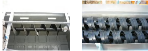
図1 スクリュー型接触材の写真 (ゴム板接着前(左) 接着後(右))
