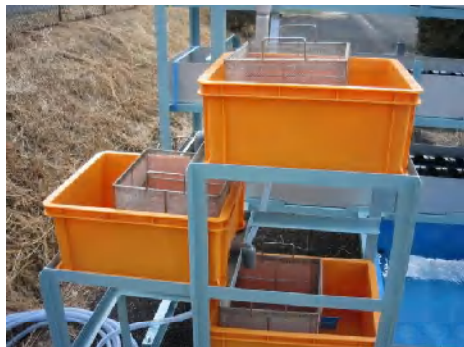
図4 3段スクリーン（上段から網目2mm、1.5mm、0.5mm）
